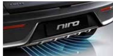
**Diffusore posteriore** Al di sotto del paraurti posteriore è presente un profilo alare dotato di nervature longitudinali che assicura stabilità e controllo aerodinamico alla vettura.
