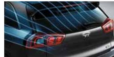
**Spoiler posteriore** Sopra il lunotto è collocato uno spoiler che sfrutta il flusso dell'aria per stabilizzare il veicolo alle velocità sostenute e ridurre i consumi di carburante.
