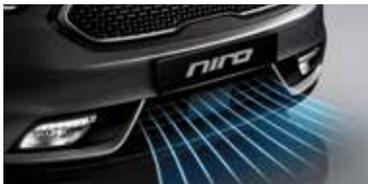
**Flap aerodinamico attivo** Il flap aerodinamico attivo dietro la griglia anteriore si chiude alle velocità elevate per ridurre i consumi e migliorare le prestazioni, consentendo sempre il raffreddamento del motore.
